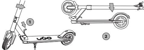
**МОНТАЖ НА ДРЪЖКИТЕ 8,5" ДРЪЖКИТЕ НА СКУТЕРА СЕ ЗАВИНТВАТ, ОТВИНТВАТ СЕ ПО ПОСОКА НА ЧАСОВНИКОВАТА СТРЕЛКА.**
